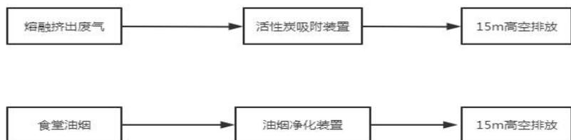
图 3.2-1 废气处理流程图
